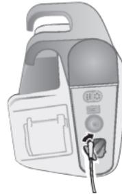
Anschlussstück zum Festziehen drehen
